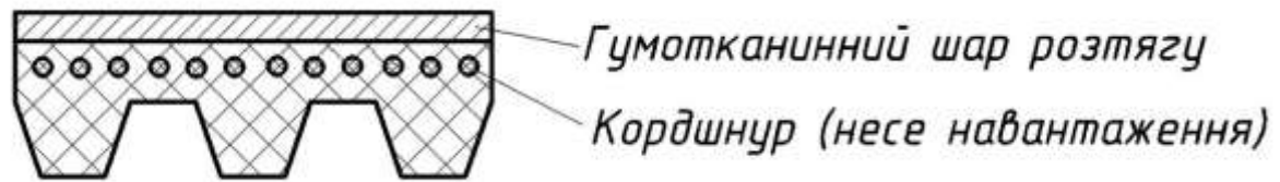
Рисунок 10.7 – Переріз поліклинового пасу
