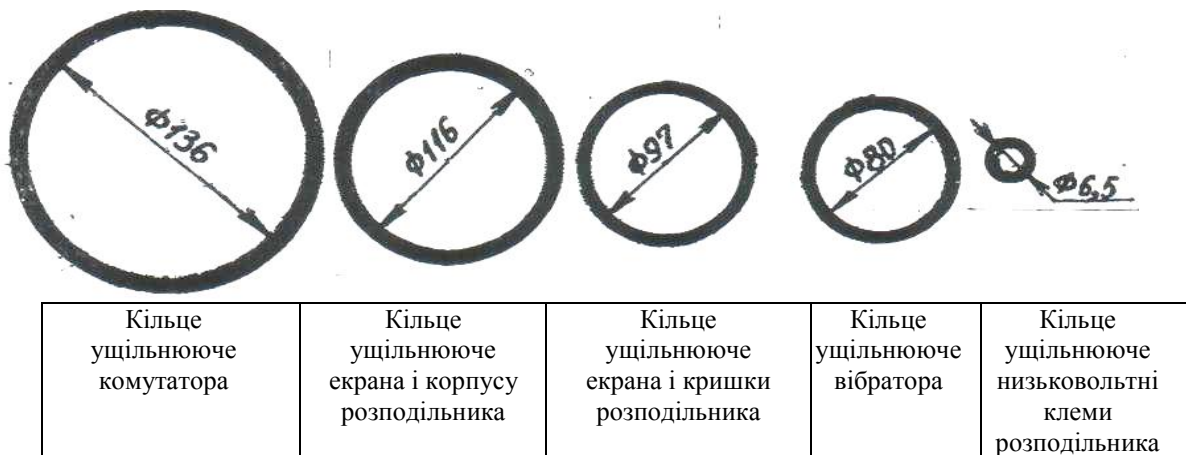
Рис. 165. Запасні частини до системи запалювання «Іскра»
