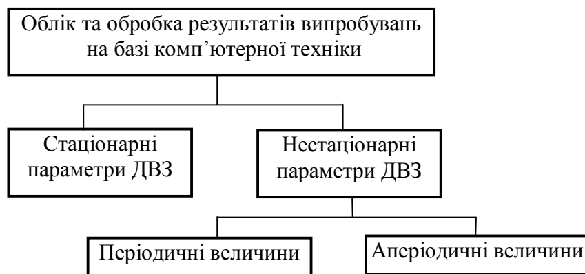
Рисунок 5.29 – Загальна класифікація вимірюваних величин при випробуваннях ДВЗ за допомогою ЕОМ
