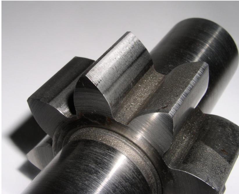
Рис. 16.24. Вершина зуба шестерні насоса НШ-32У із слідами абразивного зношування
