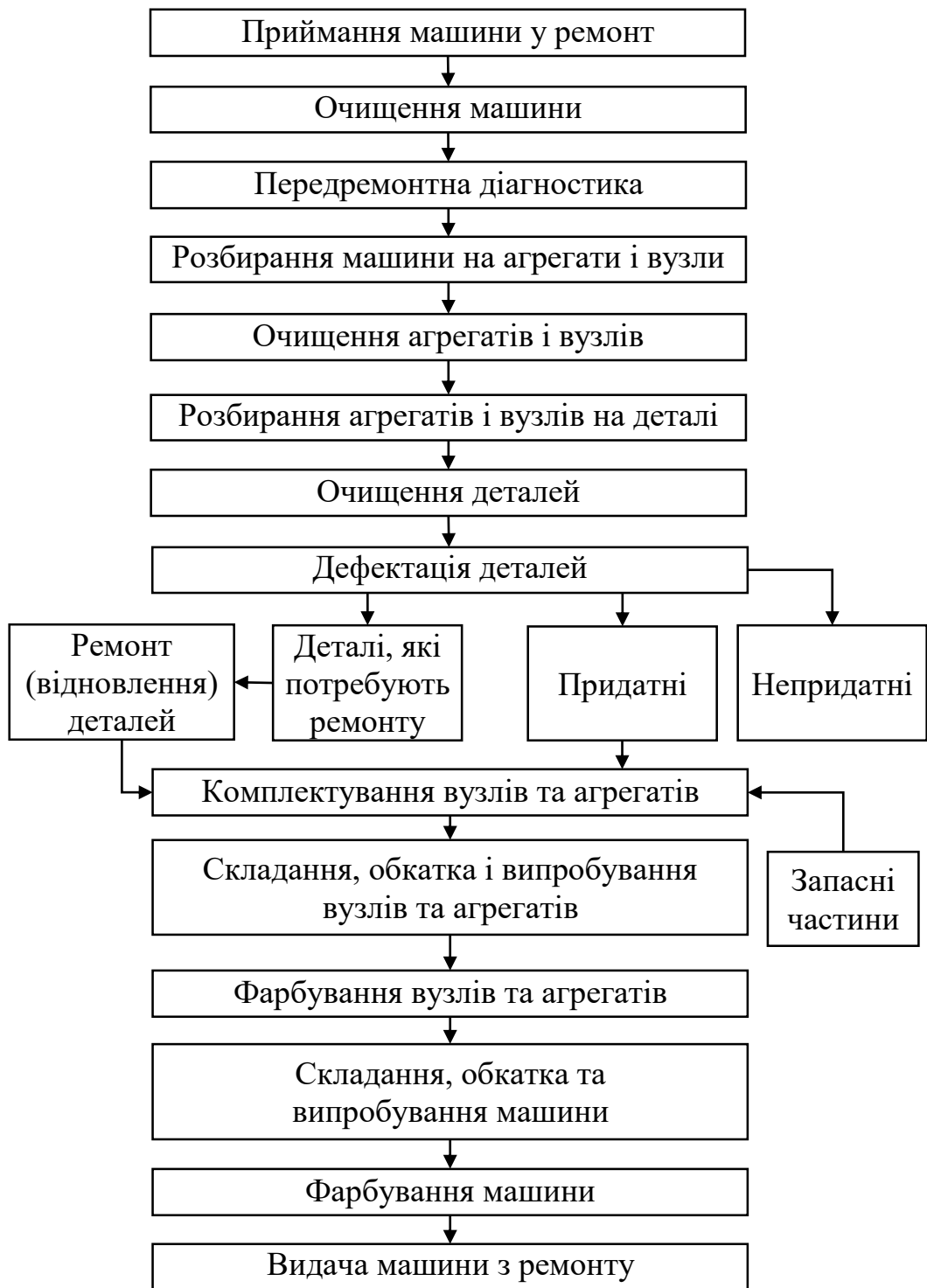
Рис. 1 – Принципова схема технологічного процесу капітального ремонту
