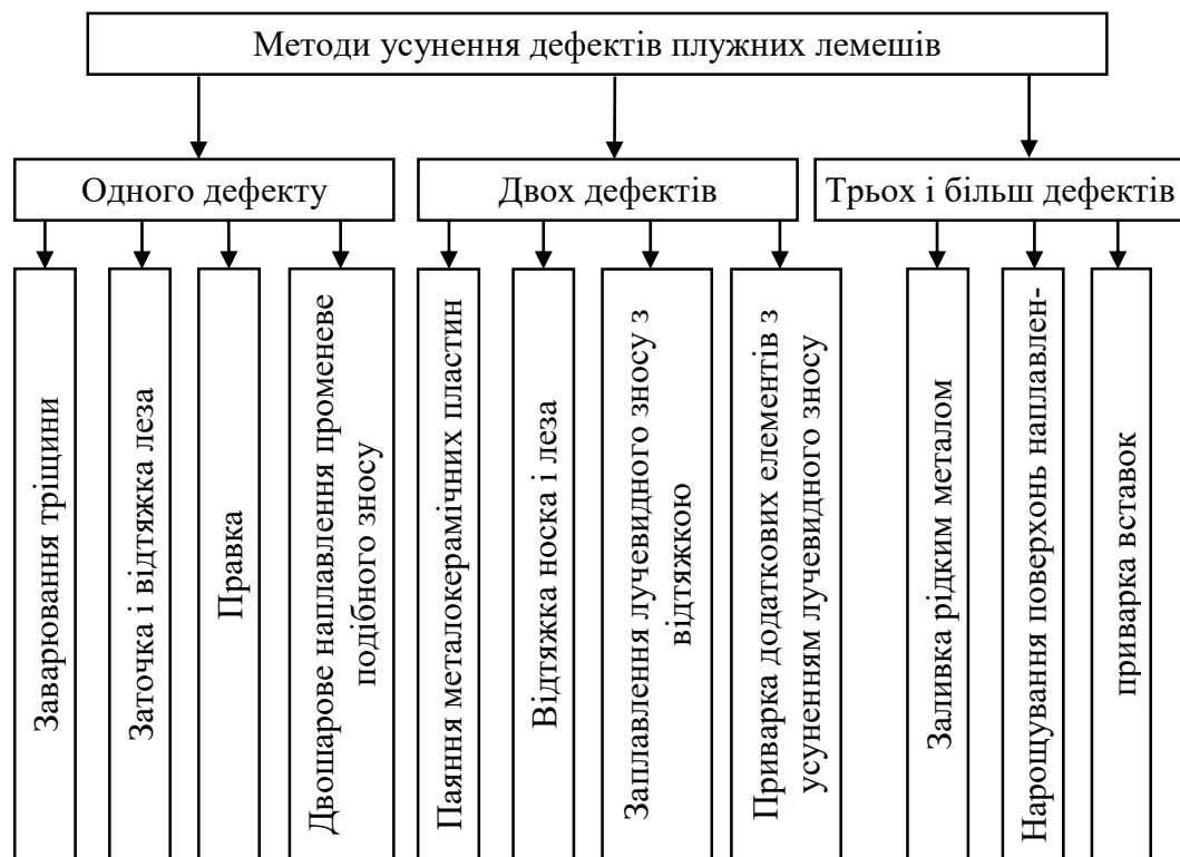
Рис. 2 – Методи усунення дефектів плужних лемешів
