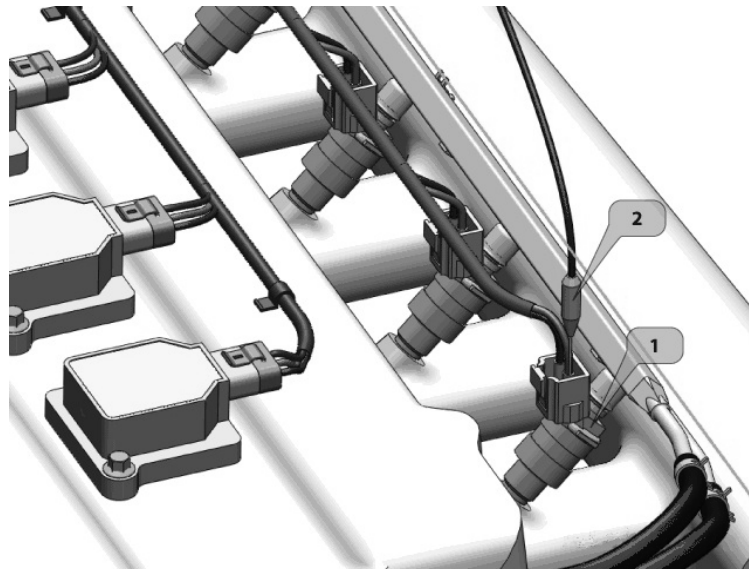
Рис. 3.130. Під'єднання вимірювального щупа до форсунки: 1 – форсунка; 2 – вимірювальний щуп з голкою
