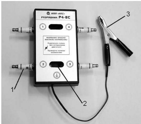
Рис. 3.84. Високовольтний розрядник Р4-8С:
