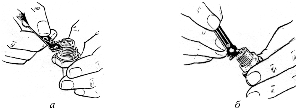
Рис. 3.69. Перевірка ( а ) та регулювання ( б ) зазору між електродами свічки запалювання
