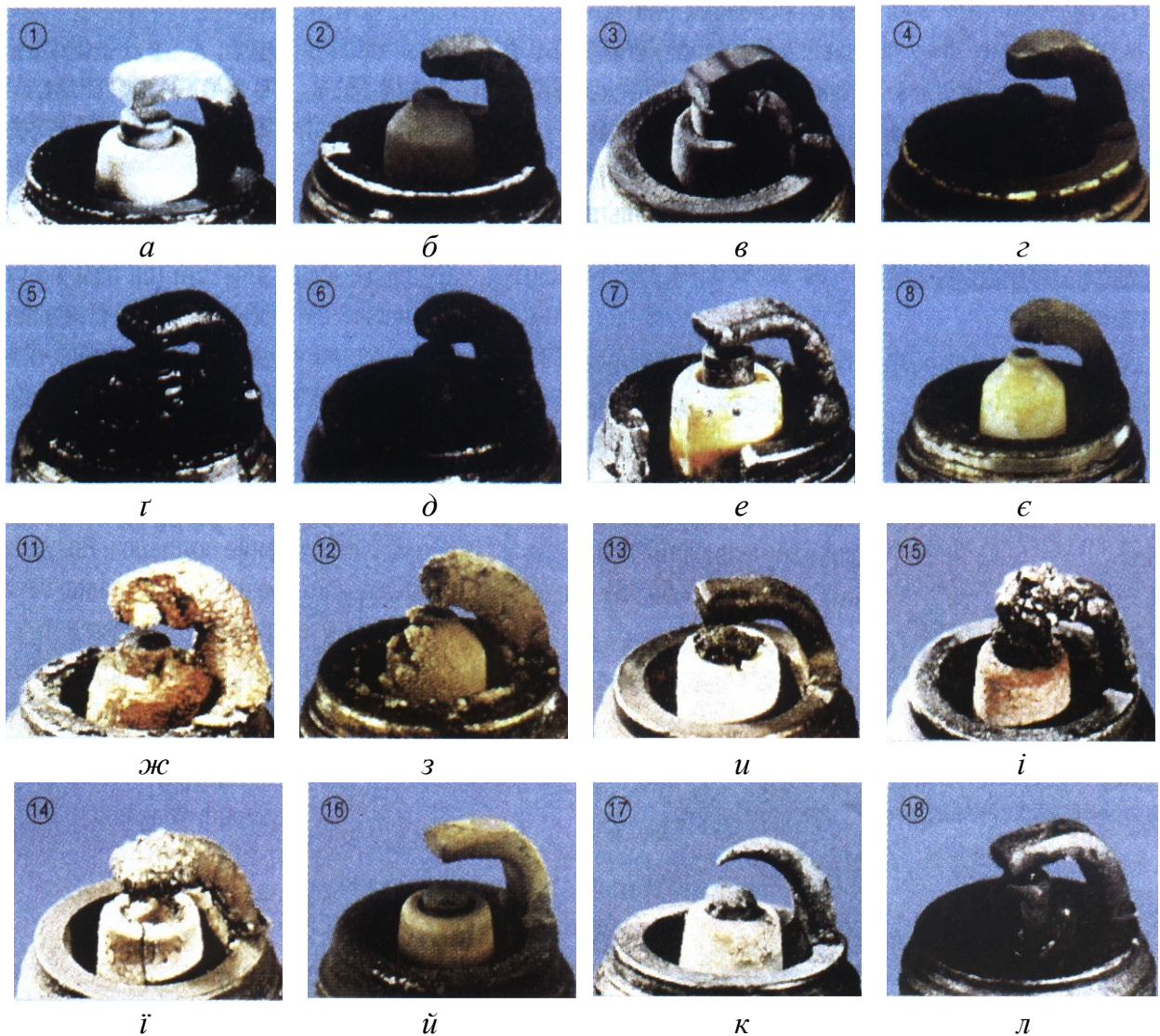
Рис. 3.68. Технічний стан свічок запалювання:
