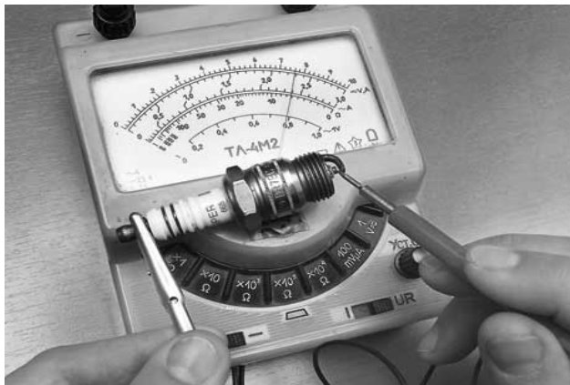
Рис. 3.93. Перевірка контакту між центральним електродом і наконечником свічки запалювання
