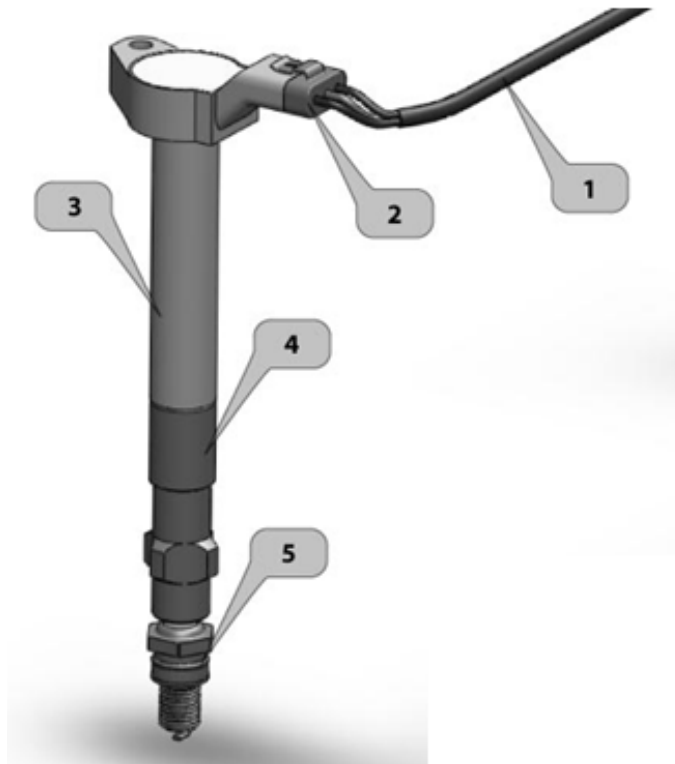
Рис. 3.114. Вигляд індивідуальної котушки запалювання:
