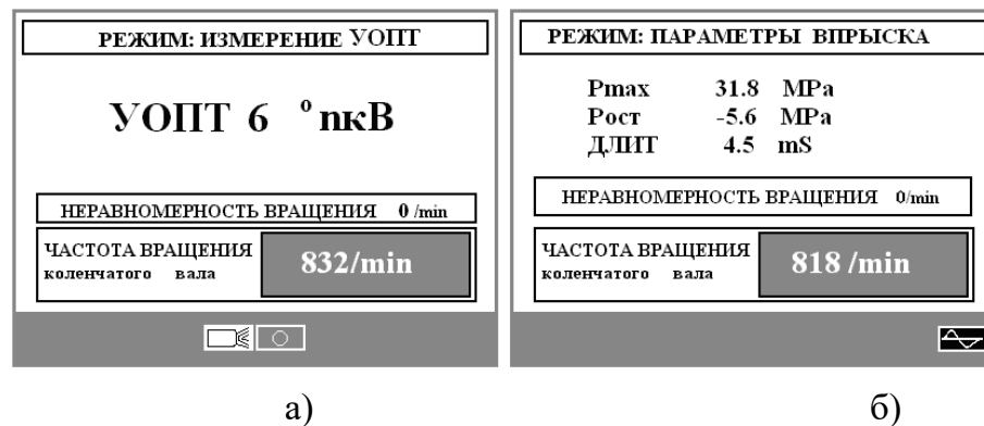
Рисунок 18.7 – Зображення на екрані мотор-тестера при діагностуванні паливної апаратури
