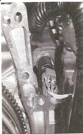
Рис. 2.124. Контакти (1, 2, 3) датчика тиску (а) у сферичному гідроаккумуляторі (б) двигуна Ford Fiesta:
