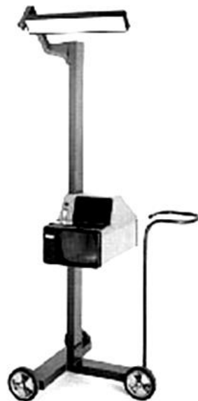
Рис.51.3. Прилад для перевірки фар EFLE 60,61 (BOSCH)
