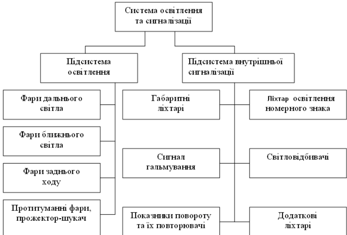
Рис.51.1. Блок-схема системи освітлення та сигналізації
