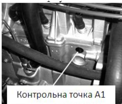
Рис. 22.1. Контрольна точка А1 та Б1 виміру вібрації
