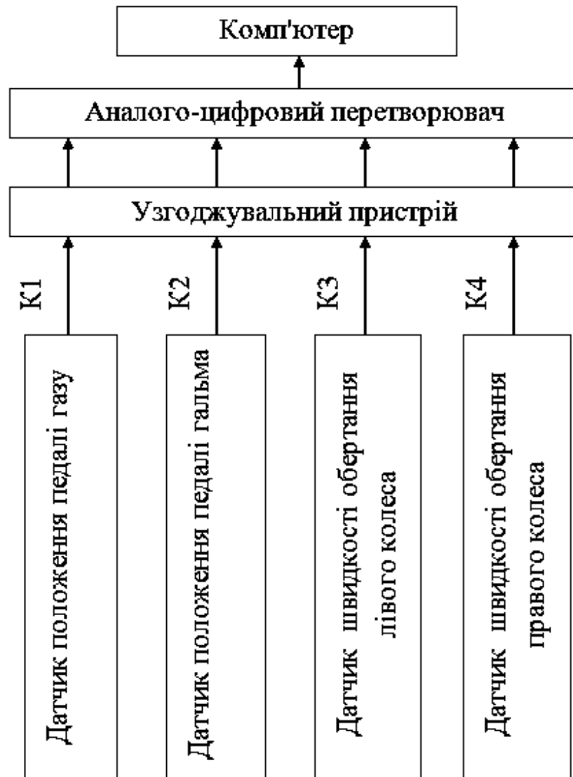
Рис.65.2. Схема підключення датчиків автомобіля і стенда до системи збору даних
