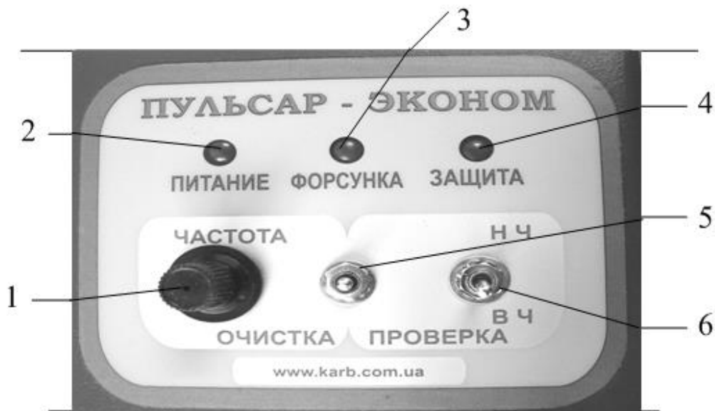
Рис.41.1. Пульт управління стенда ПУЛЬСАР–ЕКОНОМ: 1 – регулятор частоти; 2 – індикатор включення живлення (зелений); 3 – індикатор миготливий із частотою роботи форсунки (жовтий); 4 – індикатор спрацьовування захисту стенда (червоний); 5 – перемикач вибору режиму «Очистка–Перевірка»; 6 – перемикач вибору частоти
