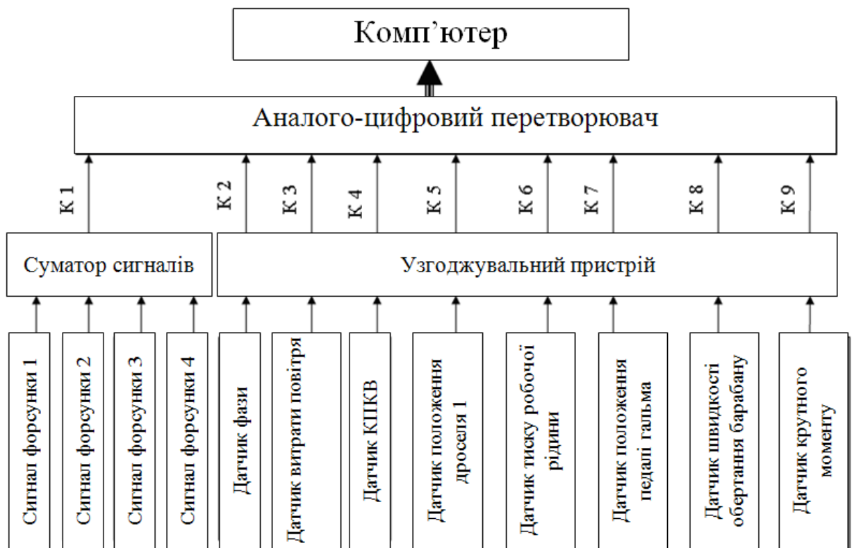
Рис.11.2. Схема підключення датчиків та виконавчих пристроїв двигуна і стенда до системи збору даних
