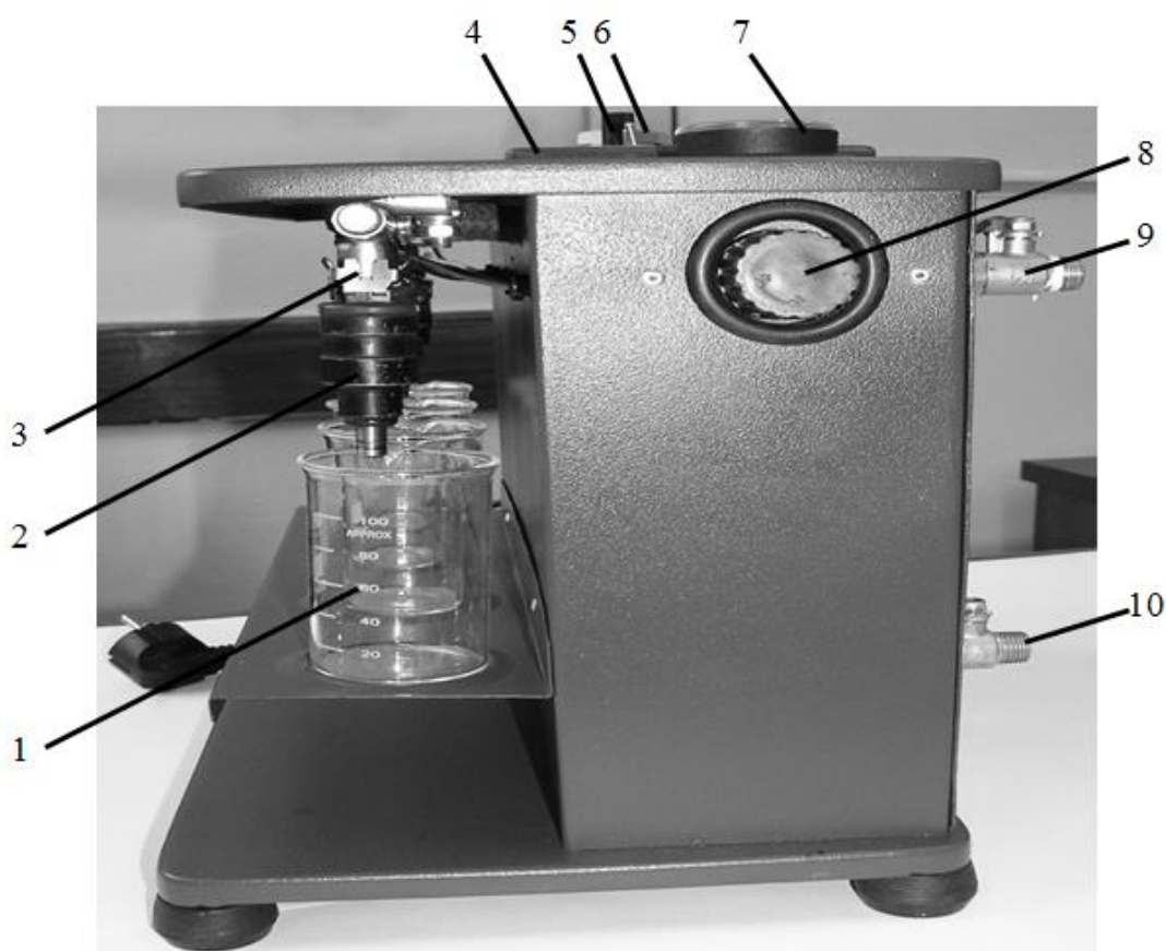
Рис.41.2. Стенд «Пульсар–Економ»: 1 – приймальні склянки; 2 – форсунка; 3 – притискні фіксатори; 4 – кришка бака; 5 – регулятор «Частота»; 6 – перемикач «Очищення–Перевірка»; 7 – манометр; 8 – регулятор тиску; 9 – штуцер підведення стисненого повітря; 10 – зливальний кран
